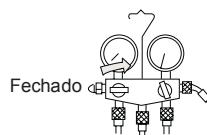
4. Abra a haste da válvula de duas vias para um ângulo contra-relógio de 90 graus. Depois de 6 segundos, feche a válvula de 2 vias e inspecione possível fuga de gás.
