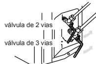
7. Para prevenir fuga de gás, gire a tampa da porta de manutenção e a tampa da haste da válvula de 2 vias e 3 vias um pouco mais do que o ponto em que o torque aumenta repentinamente.
