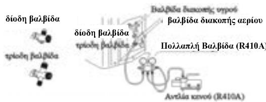
2. Ανοίξτε τη λαβή της λήψης χαμηλής πίεσης του μανομέτρου και λειτουργήστε την αντλία κενού. Εαν η κλίμακα κινηθεί και φτάσει συνθήκες κενού πολύ γρήγορα, ελέγξτε το βήμα 1.
