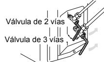
6. Desconecte la manguera de carga del puerto de mantenimiento y abra las válvulas de 2 y 3 vías. Gire el vástago de la válvula hacia la izquierda hasta que golpee ligeramente.
