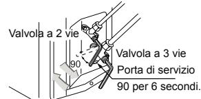
5. Non ci sono perdite di gas? Se ci sono perdite di gas, stringere i giunti del tubo. Se la perdita di arresta, procedere al punto 6. Se la perdita non si arresta, scaricare tutto il refrigerante usando la porta di servizio attenendosi alle normative vigenti. Dopo avere attivato di nuovo la pompa per il vuoto ed aspirato l'aria, riempire con refrigerante raccomandato usando la bombola del gas.
