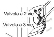
7. Per evitare le perdite di gas, ruotare il tappo della porta di servizio della valvola a 2 vie e di quello della valvola a 3 vie un po' oltre il punto di serraggio, in cui la resistenza aumenta immediatamente.
